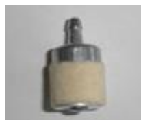
燃料フィルター詰まり発生
